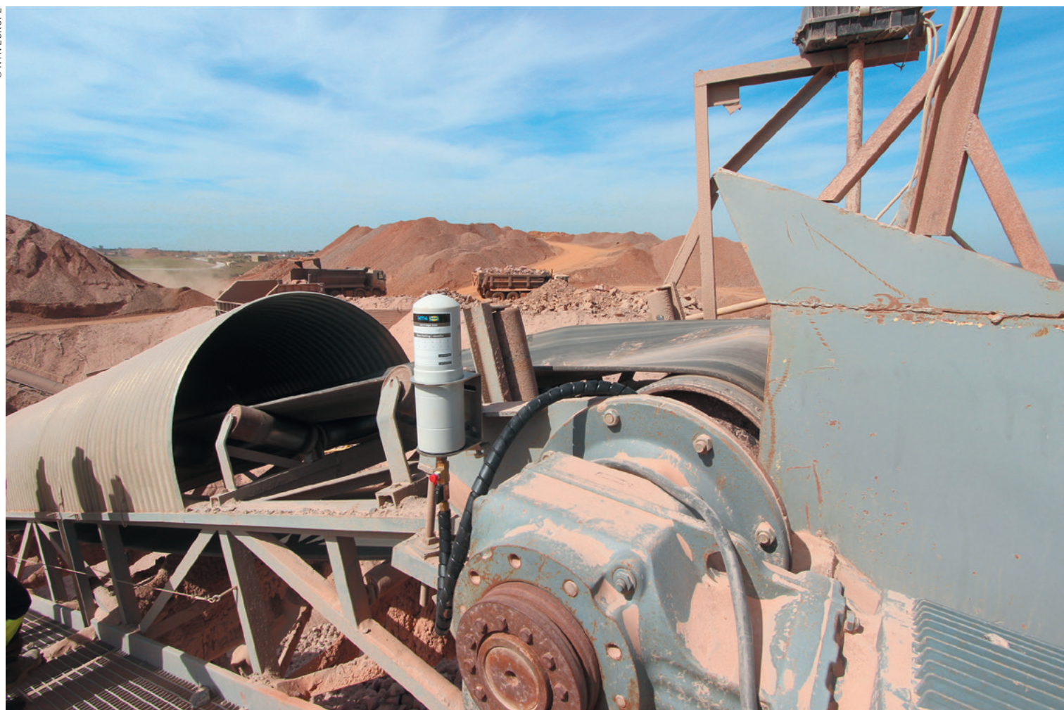
Le graisseur automatique peut être installé sur un très grand nombre d'applications, notamment les carrières.
