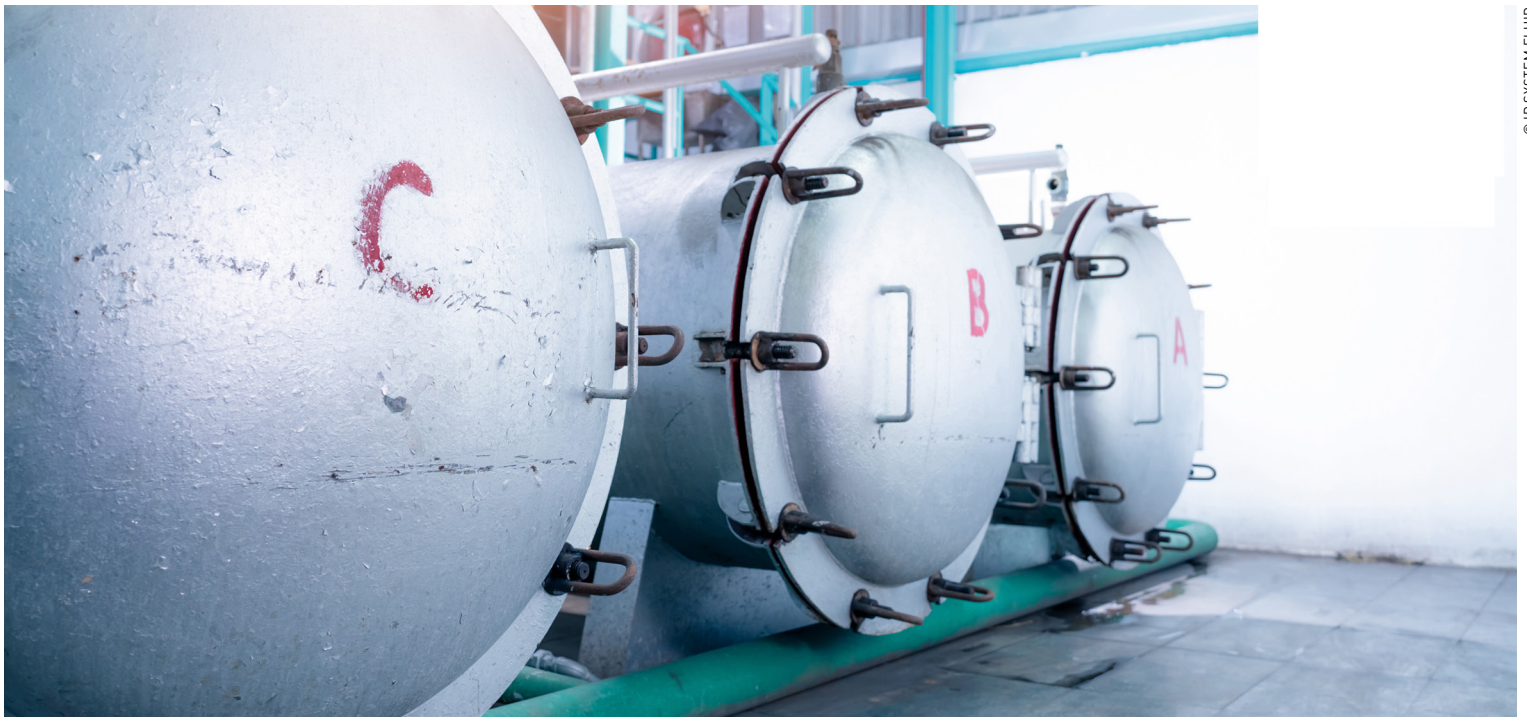
Cuve de traitement alimentaire à très haute pression avec un réservoir hydraulique de 400 litres.
