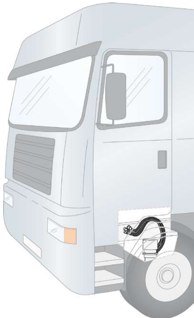
Implantation de raccords encliquetables WEO tournants pour l'alimentation de moteurs hydrauliques sur train avant de poids lourds
