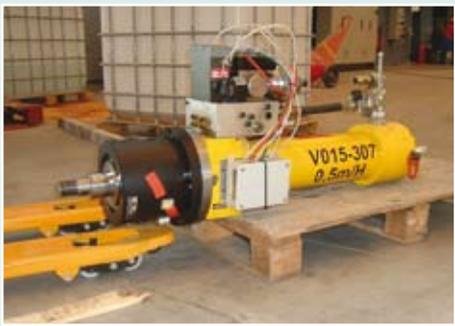
22 vérins de déformation de voilure équipés d'un bloc de régulation et d'un bloqueur Sitema ont assuré la sécurité des techniciens.
