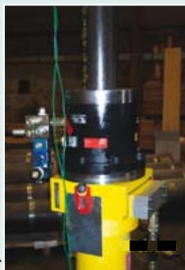
Vérin de déformation de voilure équipé d'un bloqueur de tige réglé.
