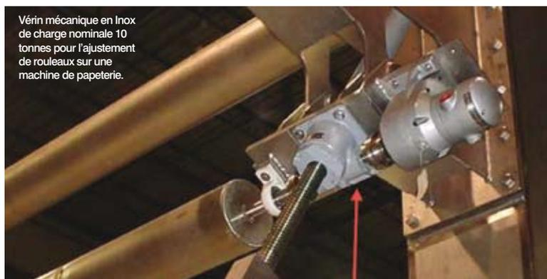
Vérin mécanique en Inox de charge nominale 10 tonnes pour l'ajustement de rouleaux sur une machine de papeterie.
