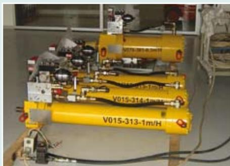
Plusieurs vérins de fuselage de 70 tonnes (en arrière-plan) sont conçus pour retenir l'avion au sol pendant le travail de leurs « petits frères » sur la voilure.
