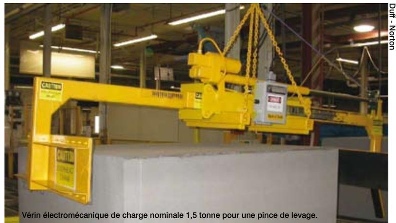
Vérin électromécanique de charge nominale 1,5 tonne pour une pince de levage.
