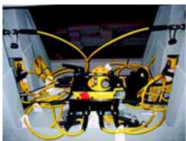
Hydraulique Enerpac pour la commande précise du système de levage et de l'arrêt de sécurité
