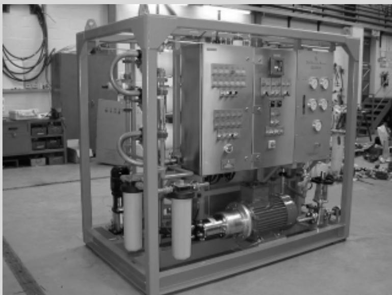
L'utilisation d'eau pure comme fluide de transmission représente un « plus » dans les applications en atmosphère explosible : les matériels en inox, les bobines ADF et un fluide non inflammable permettent aux constructeurs de machines et installations d'obtenir facilement la certification ATEX. Nombre de produits Nessie®
