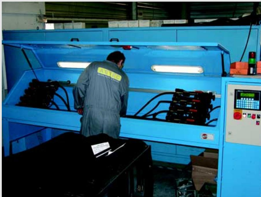
Un nouveau banc réalisé par la société Clavel vient d'être mis en service par Astec avec pour résultat de diviser par 4,5 le temps d'épreuve ! Equipé d'une pompe de mise en pression et d'une pompe de gavage, ce nouvel équipement autorise le test simultané de quatre flexibles et garantit une étanchéité jusqu'à 1.200 bar de pression.
