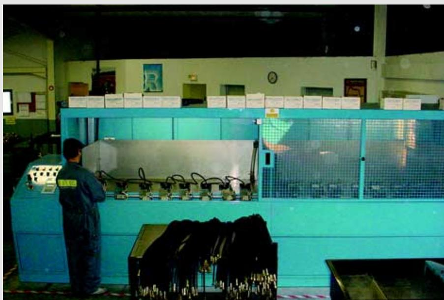
Un banc de dépollution en circuit fermé équipé de deux stations de quatre flexibles permet de garantir une propreté jusqu'à la classe 6
