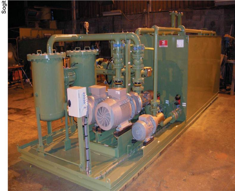
Centrale de lubrification d'une "cage à pignon" de laminoir Sogit : 803 L/min et 14 bar en service, un moteur de 37 kw et un réservoir de 14000 litres d'huile ISO VG 320.
