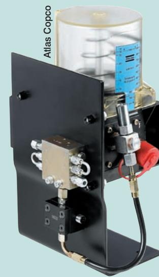
Entretien un moteur électrique de compresseur consistait jusqu'ici à injecter manuellement, toutes les 2 000 à 6 000 heures, une quantité définie de graisse dans les roulements avant et arrière de l'arbre d'entraînement. Or, 60% des cas de casse moteur ont pour origine un mauvais graissage.
