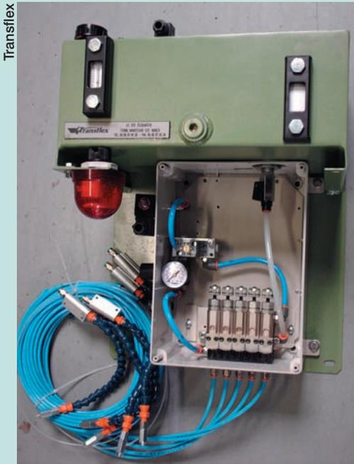
Les lames de scies à bois sont entraînées par deux volants, qui jusqu'ici n'étaient pas traités. Seule la lame était lubrifiée... au gasoil ! Avec tous les problèmes d'inflammabilité et de toxicité que cela suppose. Transflex a imaginé de lubrifier les volants avec une huile pure végétale biodégradable, « Transcie-bio ».
