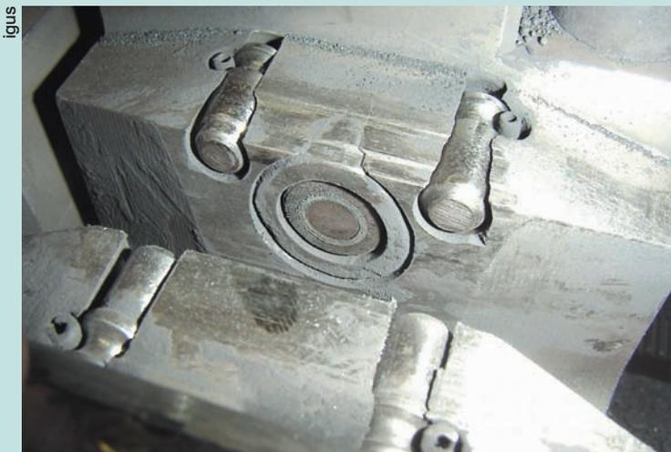
Ejecteur guidé par des douilles autolubrifiantes « DryLin R » d'igus.
