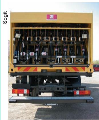
Une flotte d'une trentaine de camions de lubrification Sogit assurent les interventions de maintenance sur les systèmes de chantier et embarqués : vidange, graissage des engins de TP et de carrières...
