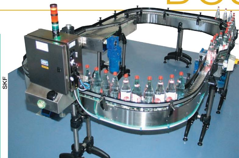
**Solution de lubrification sèche par SKF-Vogel pour convoyeurs d'embouteillages verre ou plastique Tétrapack. Les bouteilles glissaient initialement sur un tapis lubrifié à l'eau, méthode très contraignante posant des problèmes de norme environnementale et de recyclage. Le système SKF-Vogel a réglé le problème par l'application régulière d'un fin film de lubrifiant spécifique, sans eau.**
