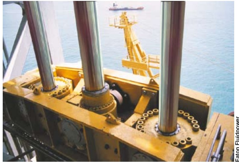
Eaton Fluidpower est capable d'aller moderniser l'ensemble des vérins d'une plate-forme pétrolière, revêtement de la tige, renouvellement des étanchéités et dossier technique compris, dans un délai de 2 mois entre le démontage et le remontage inclus.
