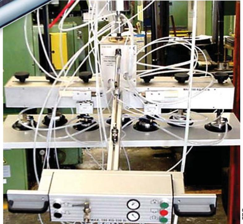
FBO-Produits Pneumatic Union a développé un vérin télescopique d'aide à la manipulation associé à une préhension par ventouse pour la mise en palette de bidons de 25 litres de peinture.
