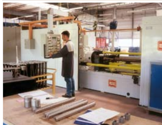
Les usines Serta sont équipées de machines de soudure par friction
