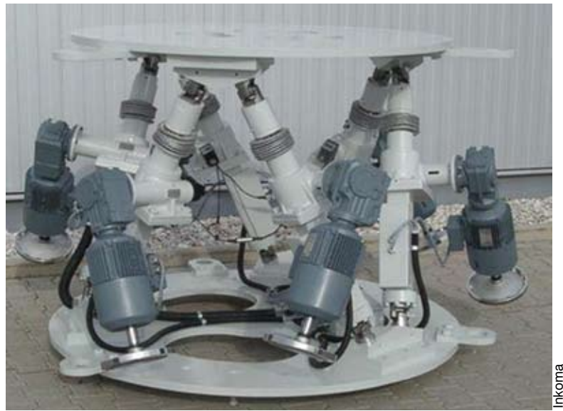
Exemple d'application de vérins électriques Inkoma sur une table de soudage Hexapod.
