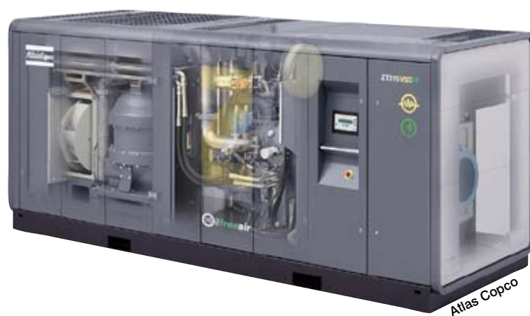
Ce compresseur à vis exempt d'huile ZT315VSD-F avec sécheur intégré est entraîné par vitesse variable. Il délivre directement de l'air propre. Il n'y a pas d'huile dans la chambre de compression et donc pas de pollution de l'air engendré par le compresseur.
