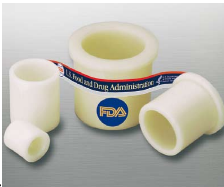
Le nouveau matériau iglidur A 180 d'Igus est un polymère haute performance spécial homologué par la FDA. Il résiste à des températures allant jusqu'à 90°C et se distingue par une faible absorption d'humidité.
