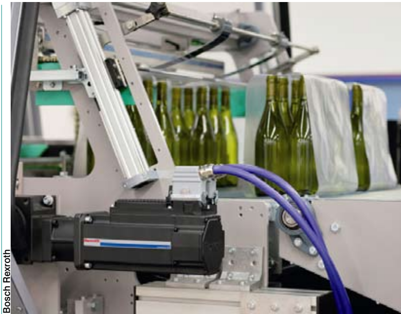
Le système complet d'entraînement d'axes IndraDrive Mide Bosch Rexroth accroît la flexibilité des lignes de conditionnement en augmentant la modularité des installations.
