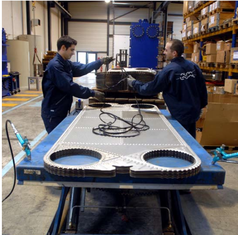
Chaque lot de plaques est inspecté avant rejointage dans le nouveau centre de maintenance des échangeurs
