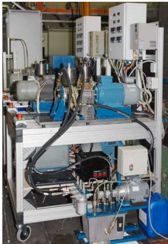
Pamas utilise la technologie volumétrique sur tous ses appareils, ce qui permet un comptage précis de l'ensemble des particules. Photo : montage du compteur en ligne sur un banc d'essai
