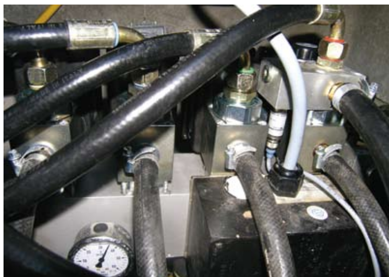
Ancienne solution, avec rampe distributrice
