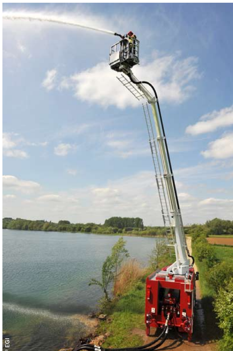
La société EGI fabrique des bras élévateurs aériens destinés à être montés sur véhicules et utilisés pour l'élévation de personnels et la lutte contre le feu
