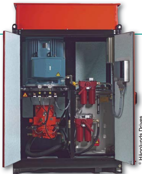
Centrale hydraulique type PEC constituée d'un réservoir, d'une pompe et d'un moteur électrique positionnés en vertical. La centrale est complètement capotée, isolée sur un plan phonique. L'interface utilisateur « spider » est positionné sur la porte.
