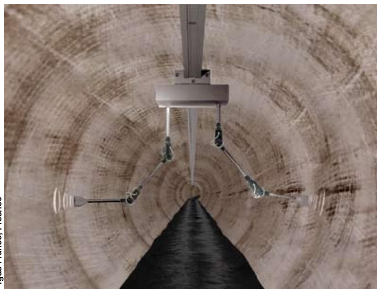
Les articulations pluri-axiales légères et non corrosives d'igus ont de multiples usages, notamment pour l'inspection d'égouts ou (sur la photo) de pipelines.
