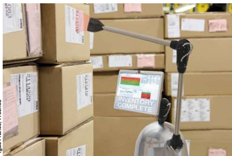
Articulations pluri-axiales robolink légères et sans entretien pour la robotique mobile, destinées ici à scanner les étiquettes dans un entrepôt de marchandises.
