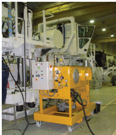
Banc de dépollution et dialyse en atelier pour les engins vibrateurs SERCEL.
