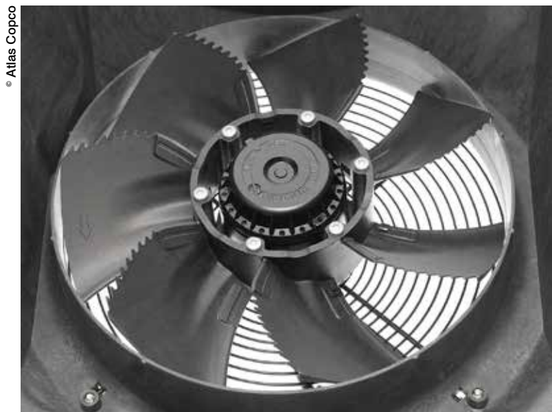
Conséquence du refroidissement par huile, de la meilleure efficacité du système de refroidissement air/huile et de l'absence de ventilateur en bout d'arbre, le niveau sonore est réduit de plusieurs décibels.
