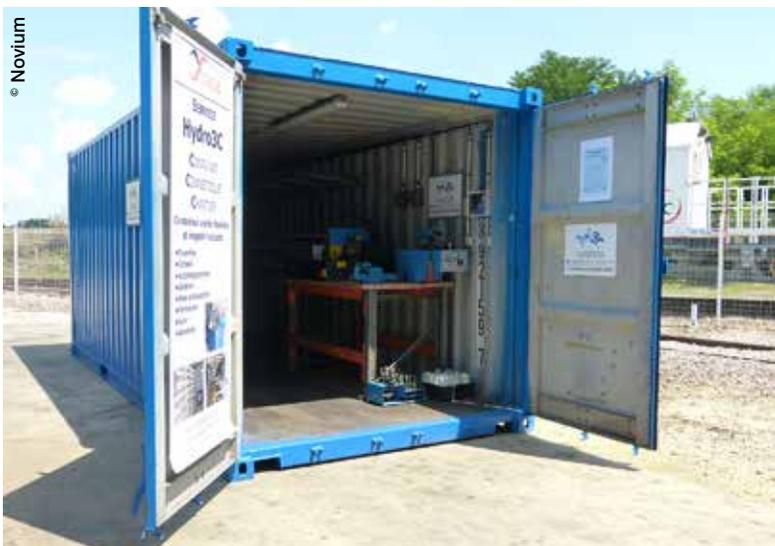
Le service Hydro 3C (Container, Connectique, Chantier) proposé par le groupe Inicia, porte sur l'installation sur les chantiers de containers équipés de flexibles, tubes et raccords hydrauliques et des outils nécessaires à leur confection (tronçonneuse, sertisseuse...).
