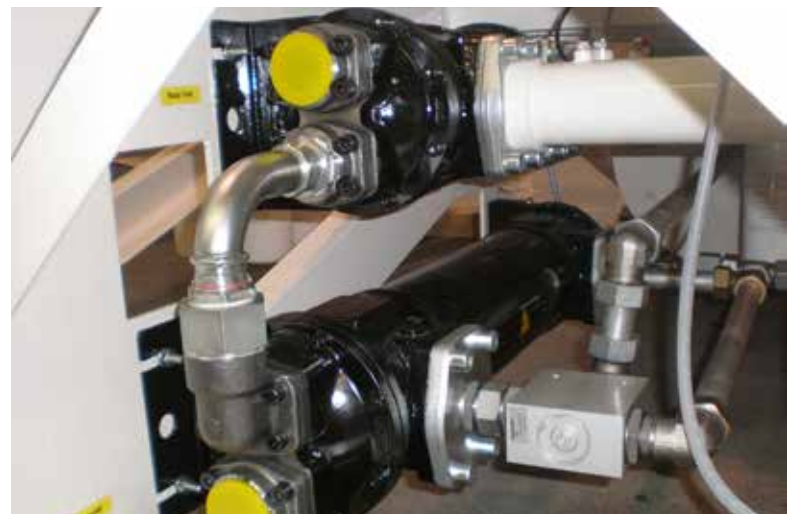
4. Echangeur thermique tubulaire BNZ dans un compresseur à vis d'Aerzen Niederlande B.V.
