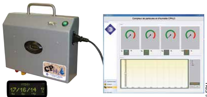
Les appareils de mesure deviennent des objets connectés capables de transmettre à distance et sans fil les données recueillies.
