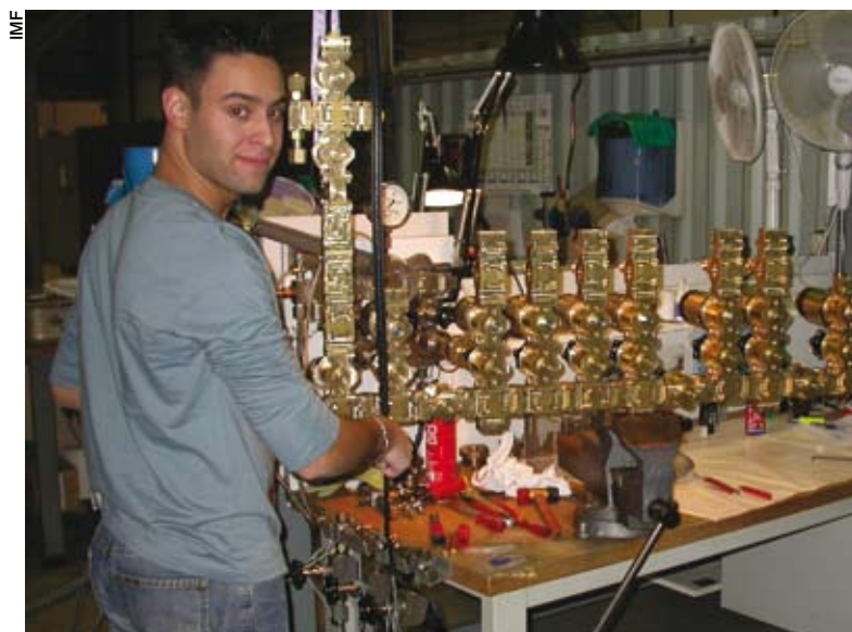
Ligne intégrabloc en cours de montage
