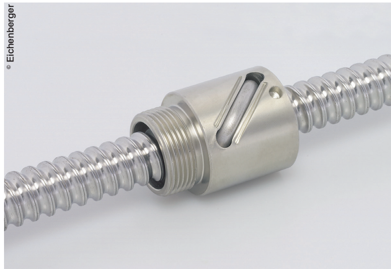
Carry type FGR : écrou standard avec nez fileté à recirculation à billes par tube intégré
