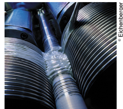
Le filetage par roulage constitue le cœur du métier d'Eichenberger
