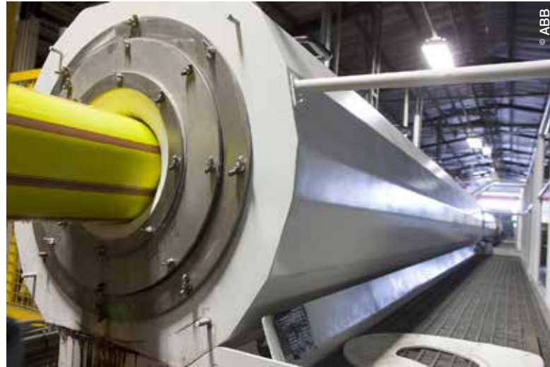
Radius produit des tuyaux en polyéthylène de 16 à 1 200 mm et des raccords destinés aux sociétés de service public pour le transfert du gaz et de l'eau
