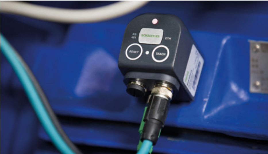
Le SmartCheck, un système de surveillance en ligne dédié à la surveillance en continu et décentralisée des machines et des paramètres du processus.
