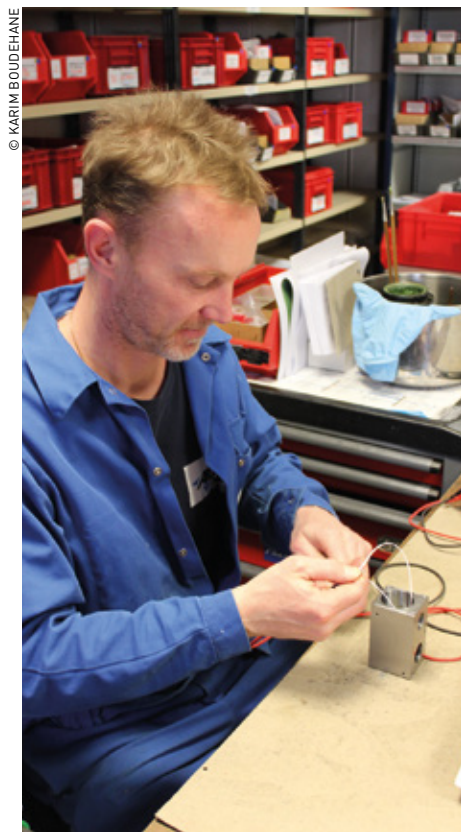
Distributeur hydraulique en cours de montage.
