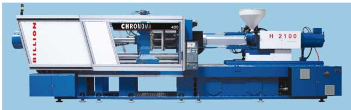
La Chronoma est équipée de régulation hydraulique, de guidages linéaires et de capots en profilés Rexroth.
