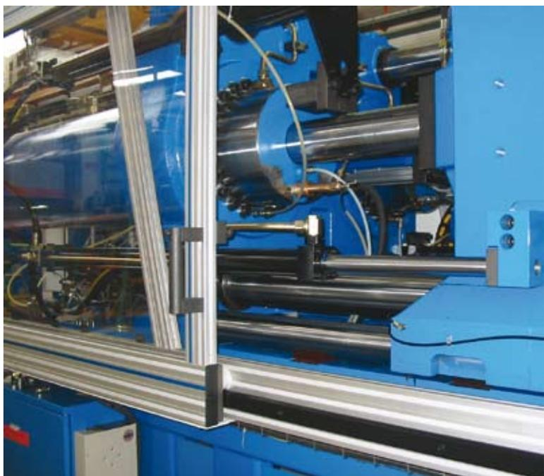
Habillage de machines réalisé en profilés aluminium pour plus de maniabilité et de flexibilité
