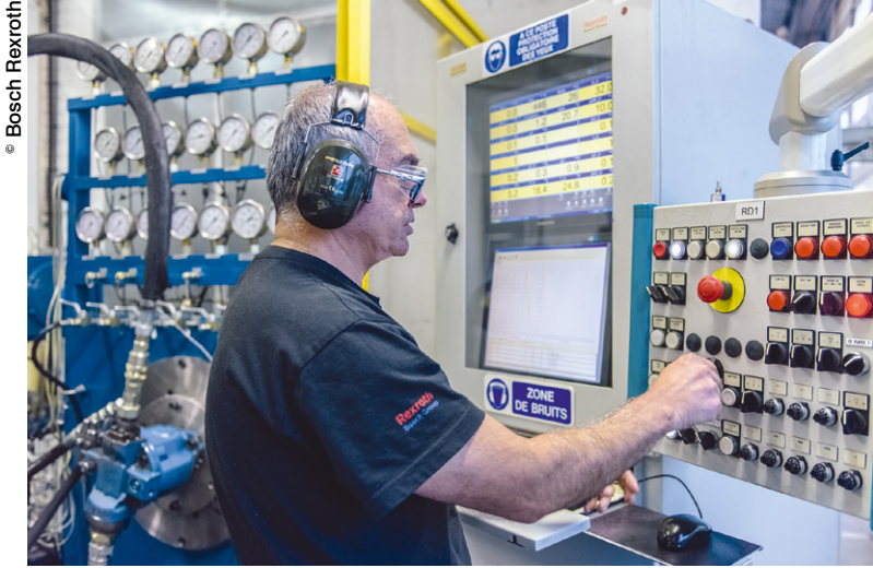
Validation des performances des produits réparés sur un banc de tests à l'usine Bosch Rexroth de Vénissieux.
