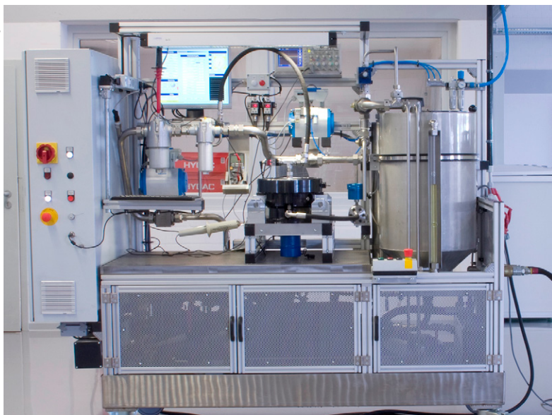
Banc Stat-Free pour la mise en évidence des phénomènes de charges et décharges électrostatiques liés à la non conductivité des fluides hydrauliques nouvelles générations.
