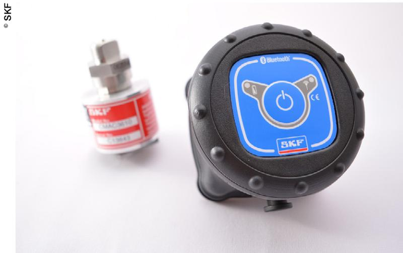
Le SKF Enlight est doté du Wireless Machine Condition Detector (WMCD), capteur mesurant les vibrations et la température et transmettant les données au Data Collect via Bluetooth.
