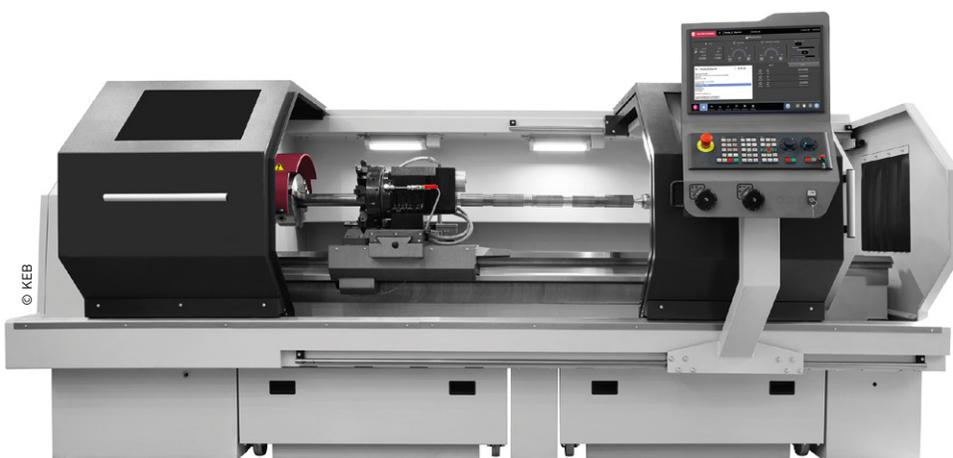
Machine à commande numérique pour l'usinage de pièces en aluminium, équipée par KEB: écran, contrôleurs d'axes, variateurs, motoréducteurs et suite logicielle pour programmer l'ensemble.
