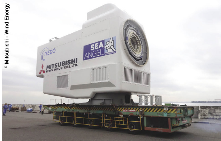
L'éolienne offshore Sea Angel, d'une puissance de 7 MW devrait être lancée sur le marché par Mitsubishi d'ici 2015.
