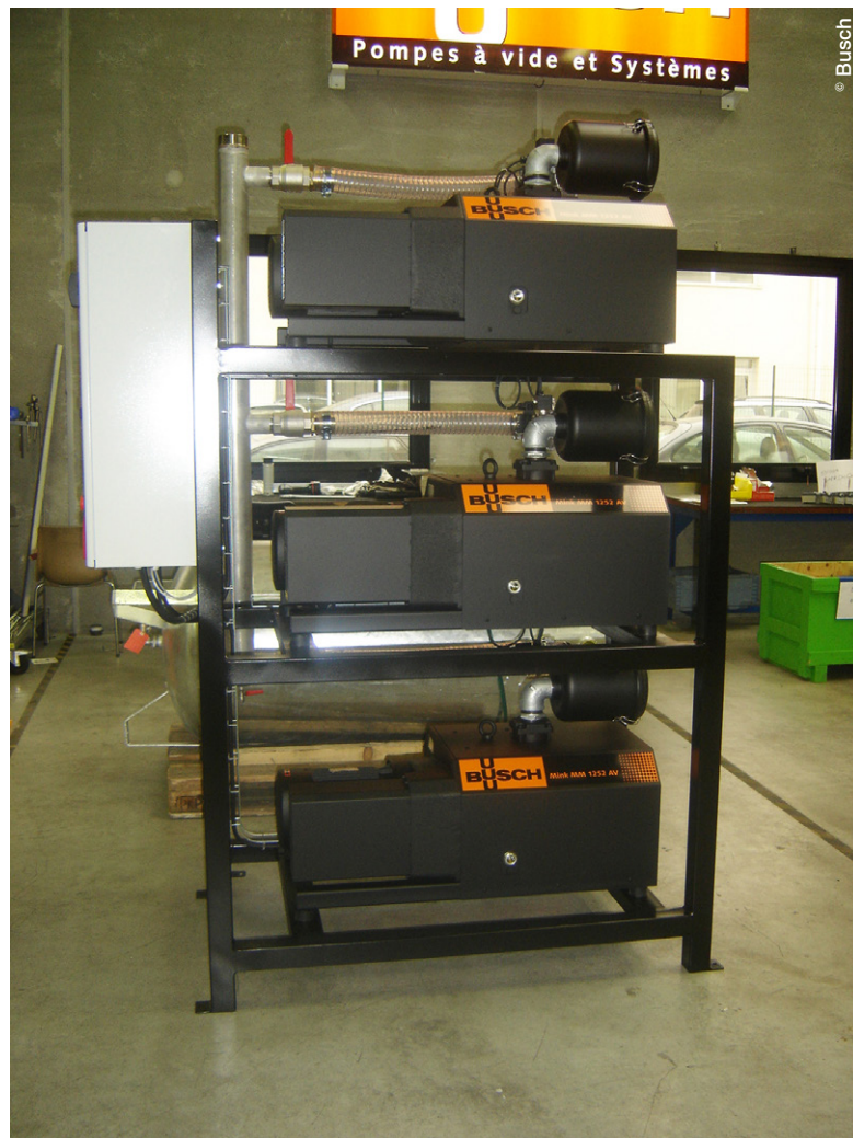
Centrale de vide avec 3 pompes Mink MM 1322
