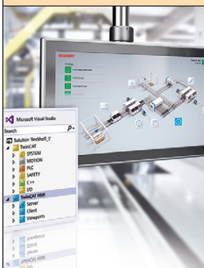
En lieu et place de systèmes propriétaires pour l'ingénierie et la communication et une utilisation sur des systèmes d'exploitation bien précis, le nouveau TwinCAT HMI mise sur des standards IT : Visual Studio® pour l'ingénierie, HTML5 pour le design et Websockets et HTTPS pour la communication sécurisée. L'interface utilisateur peut être exécutée sur n'importe quel navigateur compatible HTML5, indépendamment du système d'exploitation, de la résolution ou de l'écran.
