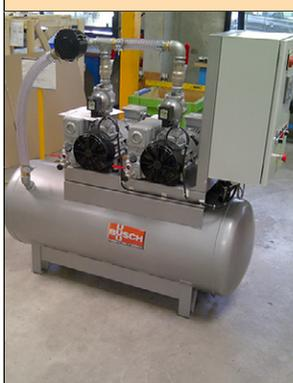
Les centrales de vide Simplex (une pompe) et Duplex (deux pompes) permettent aux petits ateliers de bénéficier d'un vide régulé et d'une optimisation des temps de fonctionnement des pompes à vide. Equipées d'un réservoir, d'un coffret électronique et d'une régulation en tout ou rien (sur électrovanne en option), elles sont majoritairement configurées avec des pompes à palettes lubrifiées. Le recours à une centrale Duplex offre de plus la sécurité d'avoir une pompe de secours.
