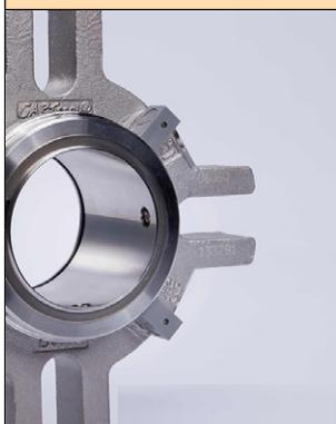
La garniture mécanique cartouche CARTseal B24 est homologuée FDA, CE 1935/2004, ACS et ATEX. Conçue pour une adaptation parfaite à tout type d'environnement, elle se caractérise par un système d'entraînement surfacique, une longueur de montage unique et des cales de montage autoécartantes. Elle se monte sur des pompes centrifuges ou volumétriques, sur des agitateurs horizontaux ou verticaux et fonctionne avec tous les fluides qu'ils soient corrosifs, abrasifs ou colmatant.
