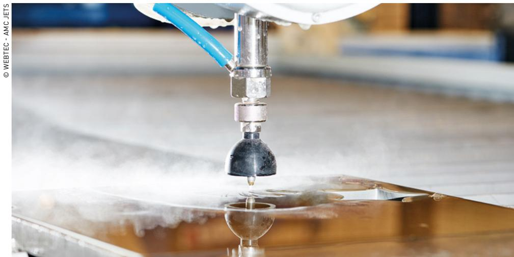
AMC Jets propose des services basés sur les technologies de coupe par jet d'eau haute pression (5.000 bar).
