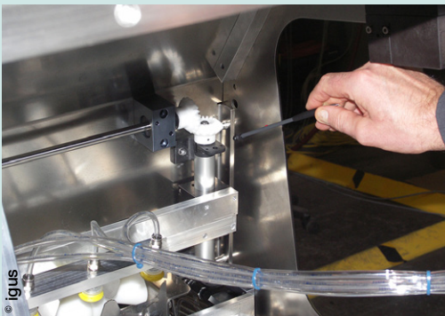
Ajustement et réglage du format d'une traverse assurant le retrait du papier entourant les glaces.
