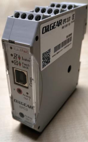
Conçu et fabriqué sur le succès des modèles précédents, le module électronique EPC3 est la troisième génération du module de commande électronique Oilgear. Revisité avec une connectique et un encombrement optimisés, ce module est un microcontrôleur utilisé pour les régulations de pompes et vannes hydrauliques à servocommande. Entièrement programmable par PC grâce à une interface puissante et intuitive, l'EPC3 se connecte en USB et ne nécessite donc aucun câble propriétaire.
