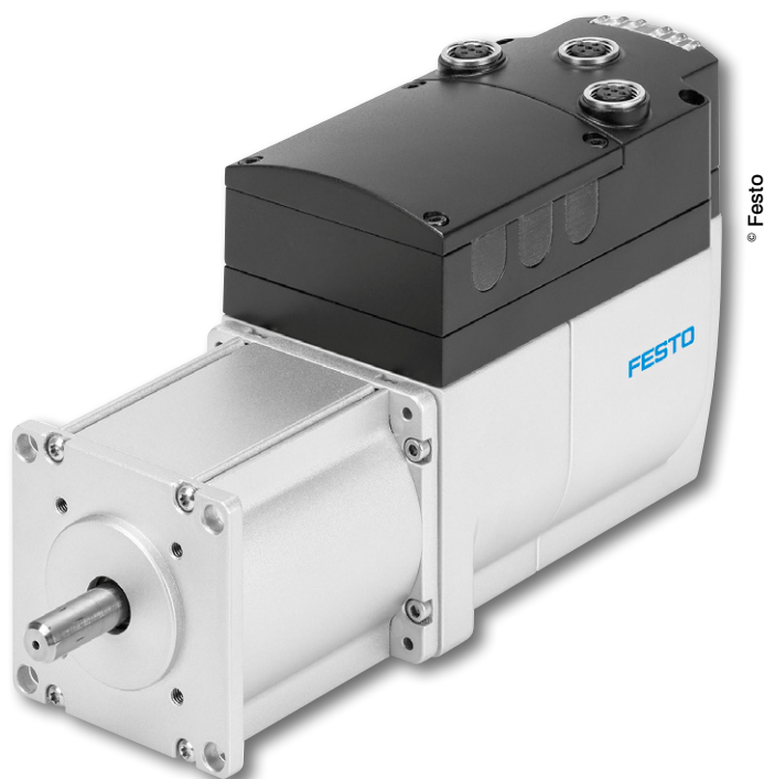
Festo a développé le moteur synchrone avec variateur intégré EMCA. Disponible tout d'abord en CanOpen, il se caractérise par sa compacité (166 x 67 x 111 mm). Il se dispense de câbles grâce à son électronique de commande intégrée et n'est alimenté qu'en 24V.
