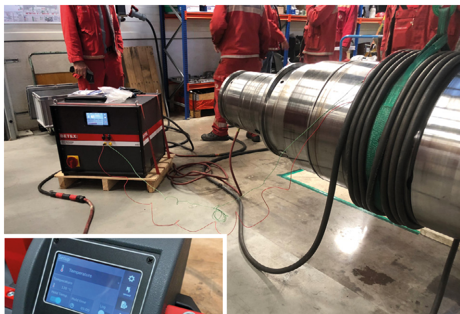
▲ Appareil de chauffage rapide Betex MF Quick-Heater : démontage de bagues de roulements en quelques minutes. ◀ Fonction de journalisation et exportation vers un dispositif USB.
