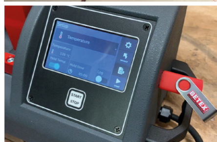
▲ Appareil de chauffage rapide Betex MF Quick-Heater : démontage de bagues de roulements en quelques minutes. ◀ Fonction de journalisation et exportation vers un dispositif USB.
