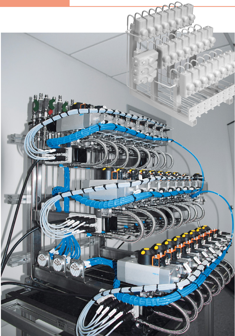
Un modèle CAO en 3D de bloc a été élaboré par Festo puis fabriqué à une échelle de 1 : 5 au sein de l'unité de prototypages rapides de Berkheim.
