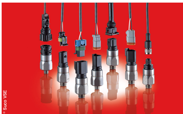
Pressostats Suco avec connecteur intégré, IP67, réglage de 0 à 200 bar, joints NBR, EPDM ou FKM.
