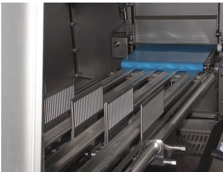
Le mouvement linéaire de la pince faisant avancer le produit à découper est assuré à l'aide d'arbres en inox tendres et de films lisses de la gamme JUM-10-40.
