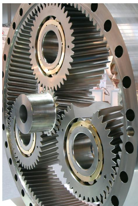
Roulements spéciaux de NKE dans un réducteur planétaire pour une éolienne de 1,5 MW.
