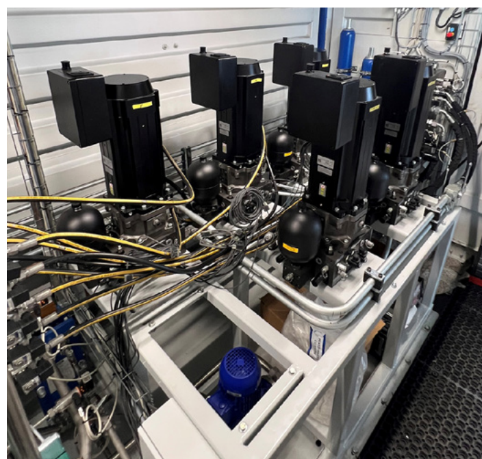
L'EPS a permis à BLUEFINS d'obtenir rapidement une centrale hydraulique clé en main, avec la garantie que les essais fonctionnels aient été réalisés en usine Moog. © Bluefins
