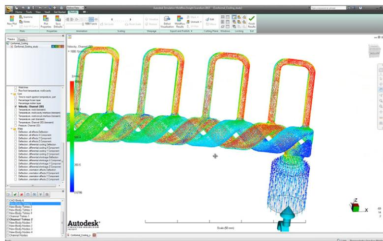
**MoldFlow, logiciel de simulation de moulage par injection de matières plastiques aide les fabricants à valider et optimiser la conception des pièces plastiques et des moules d'injection en prévoyant précisément le processus d'injection de matières plastiques.**
