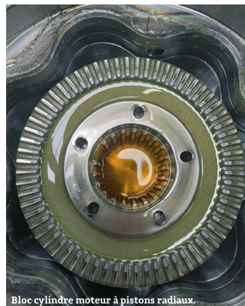
Bloc cylindre moteur à pistons radiaux.
