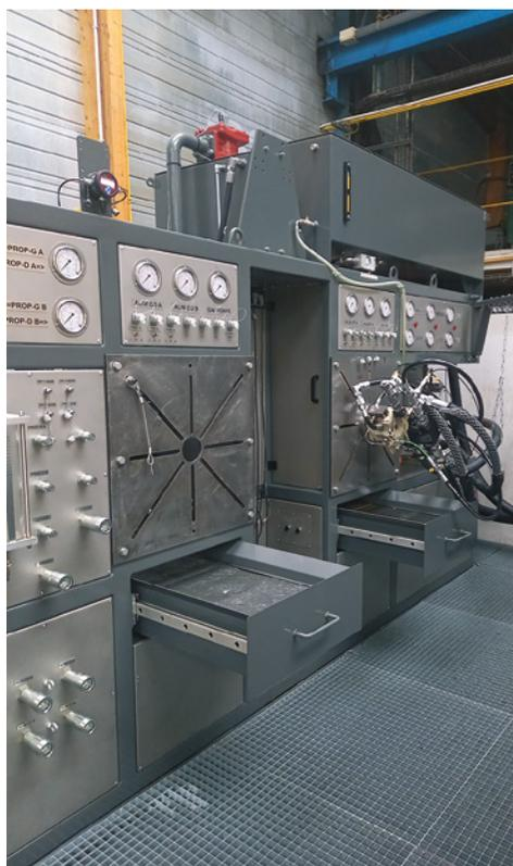
Banc d'essai pour pompes et moteurs à transmission hydrostatique.
