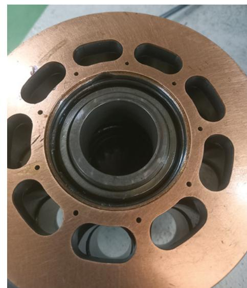
Défauts du barillet d'une pompe à pistons axiaux.
