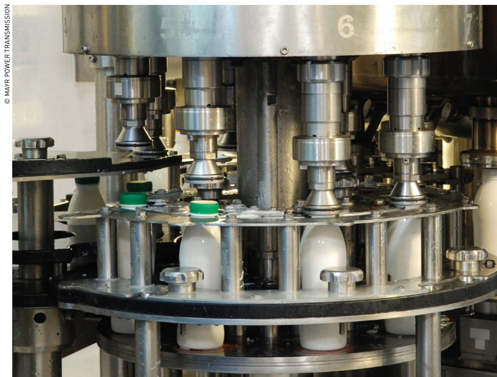
Le couple du limiteur maintient une valeur constante indépendamment de la vitesse de glissement.
