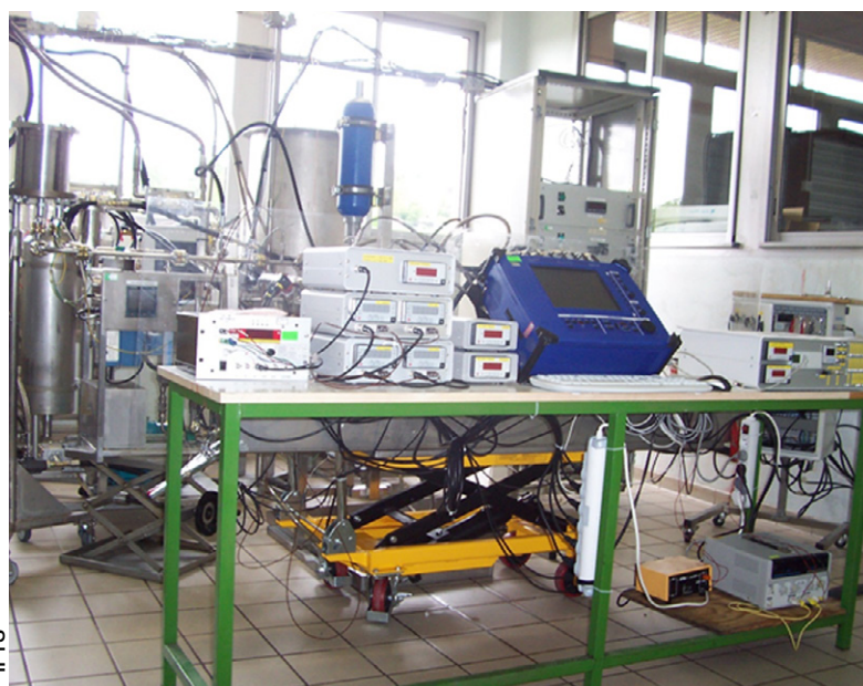
Essais d'usure de composants : jusqu'à 2 500 heures de fonctionnement continu.
