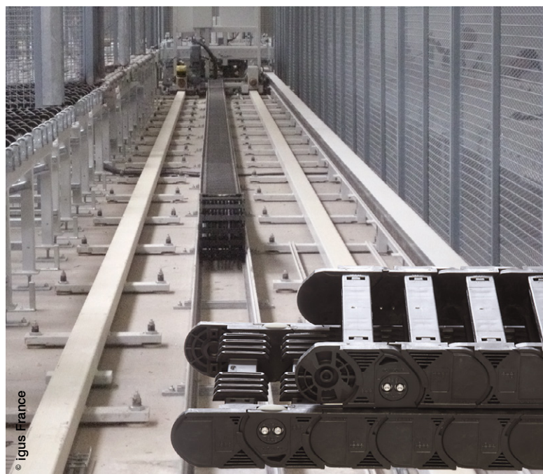
Rapide et silencieuse, la chaîne porte-câbles à roulettes P4.32 équipée de câbles chainflex d'igus assure ici l'alimentation d'un transpalette pour le transport des matériaux dans la production de tabac.
