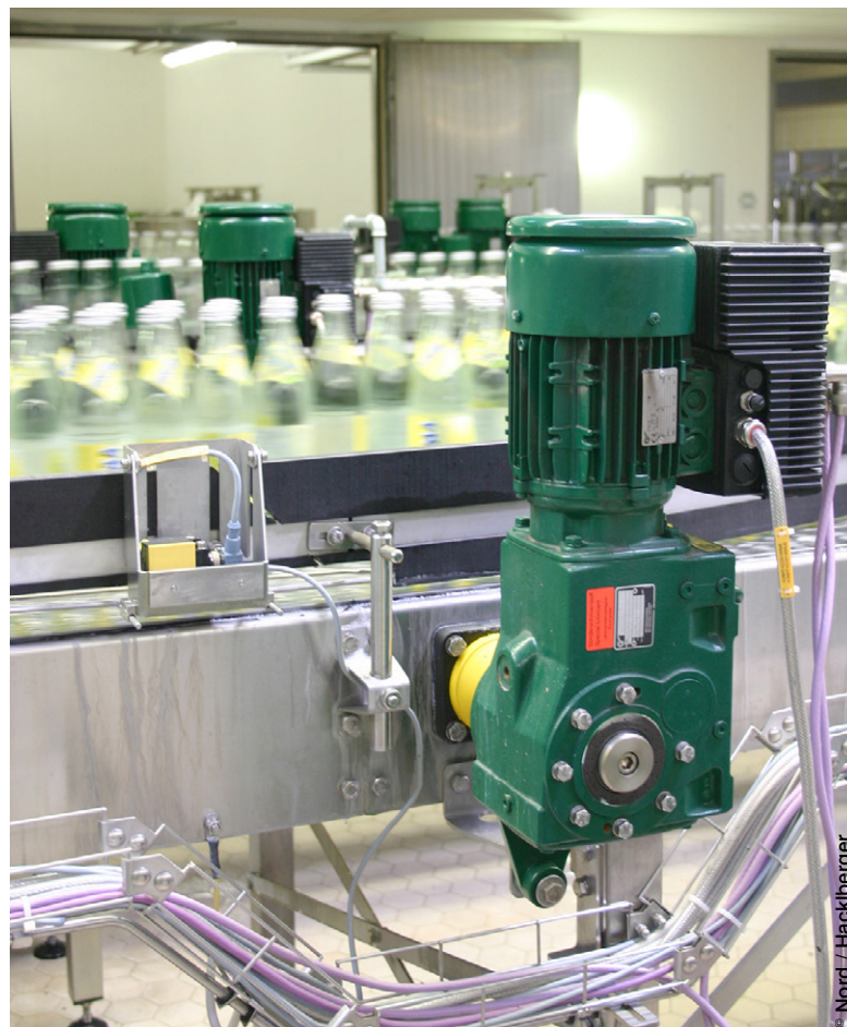
Des entraînements Nord sont montés de part et d'autre du convoyeur.
