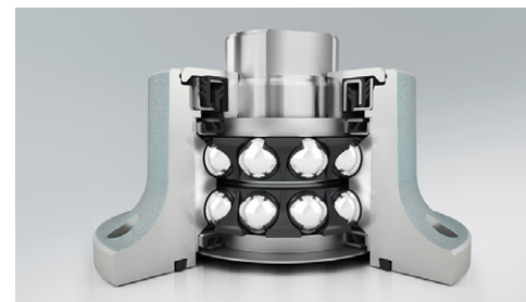
Les moyeux Agri Disc Hubs, dotés de roulements à double rangée de billes à contact oblique, peuvent absorber les charges axiales et les couples de basculement élevés.
