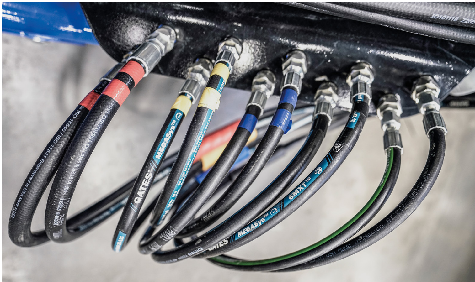
Les flexibles hydrauliques sont tous construits avec une combinaison de composites élastomères de haute technicité.
