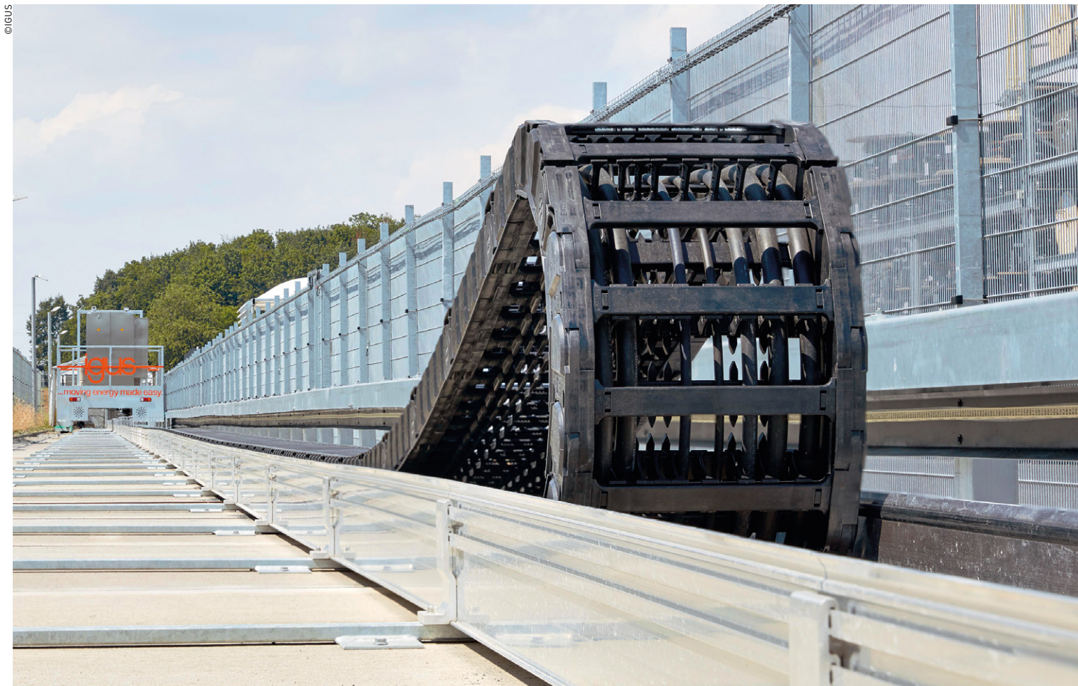
Sur le banc d'essais automatisé destiné aux courses longues, des chaînes porte-câbles en polymères et des câbles sont testés à une vitesse allant jusqu'à 8 m/s sur une course de 400 mètres.
